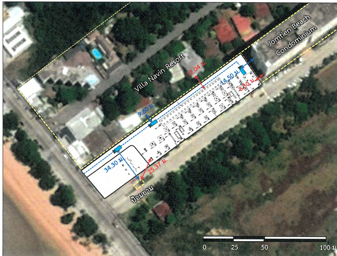
รูปที่ 4.1.6-2 ผังแสดงระยะห่างจากเสาเข็มกับอาคารข้างเคียง และระยะห่างรบบรทุกกับอาคารข้างเคียง ในระยะก่อสร้าง
