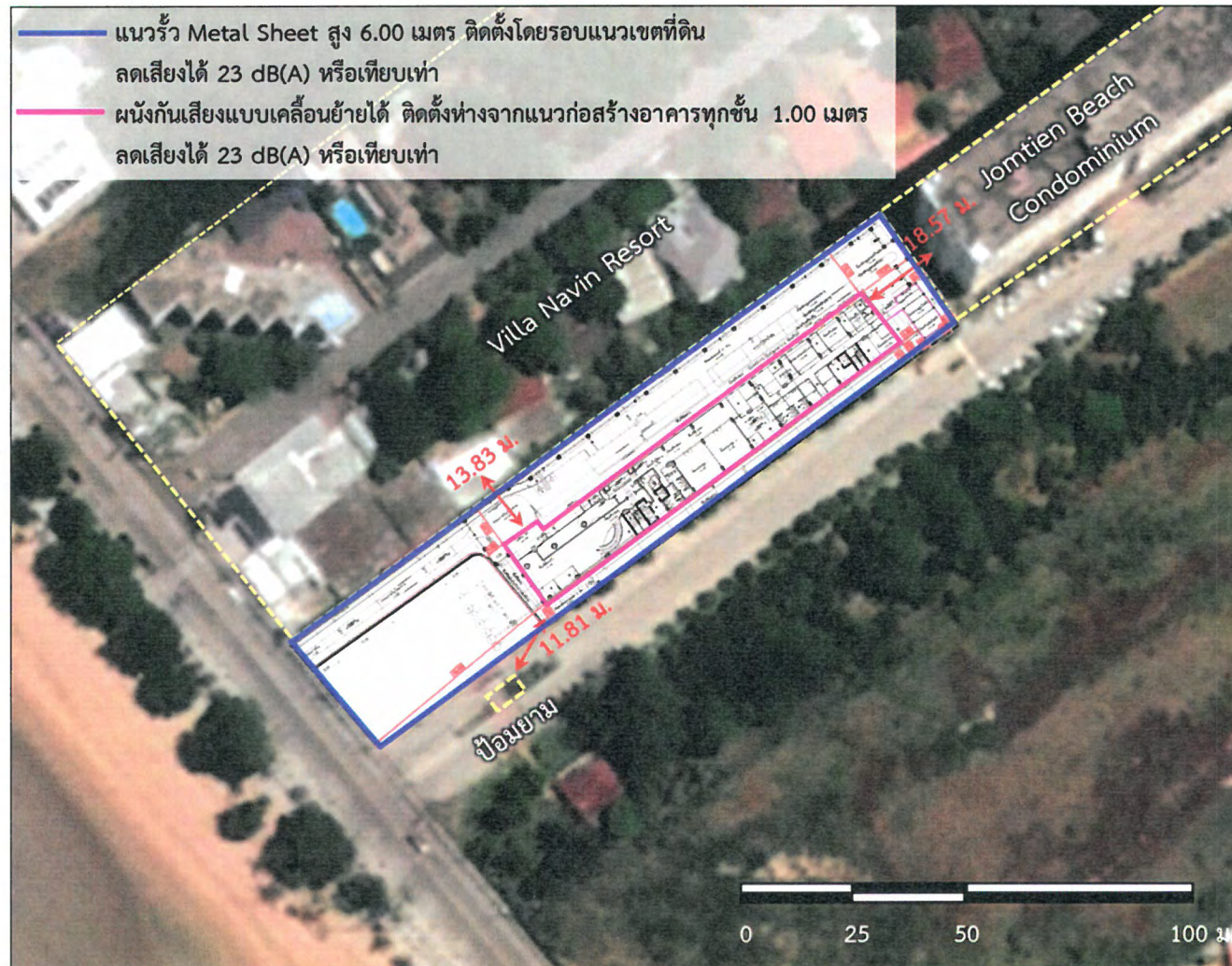
รูปที่ 4.1.5-5 ผังแสดงแนวรั้ว Metal Sheet ที่เป็นกำแพงกันเสียงโดยรอบโครงการ (ระยะก่อสร้าง)
