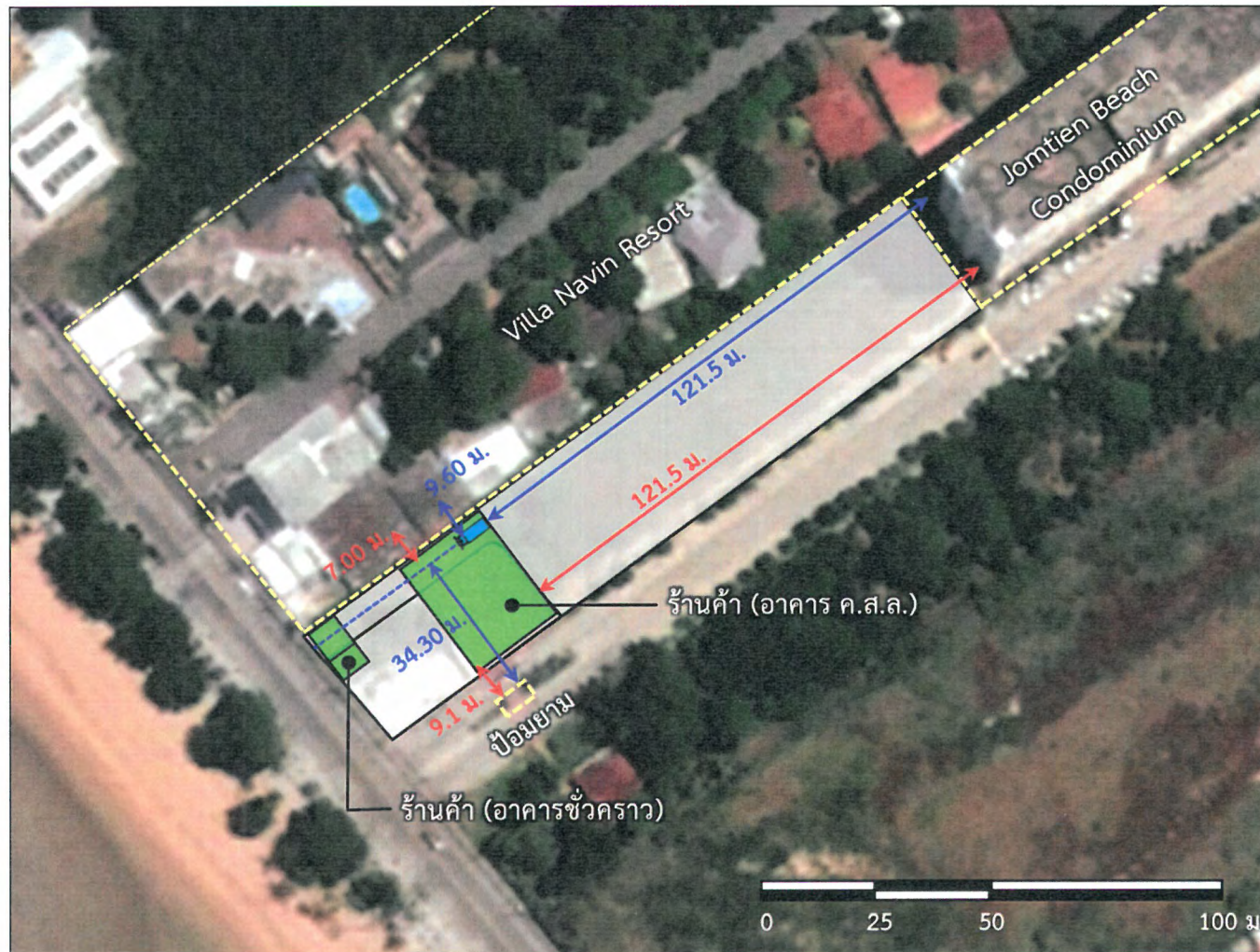
รูปที่ 4.1.6-1 ผังแสดงระยะห่างอาคารที่รื้อถอนกับอาคารข้างเคียง และระยะห่างรบบรรทุกกับอาคารข้างเคียง ในระยะรื้อถอน
